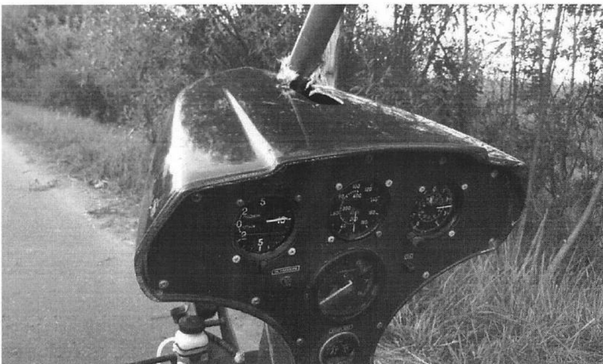
Фото 2. Повреждение обшивки обтекателя приборов
