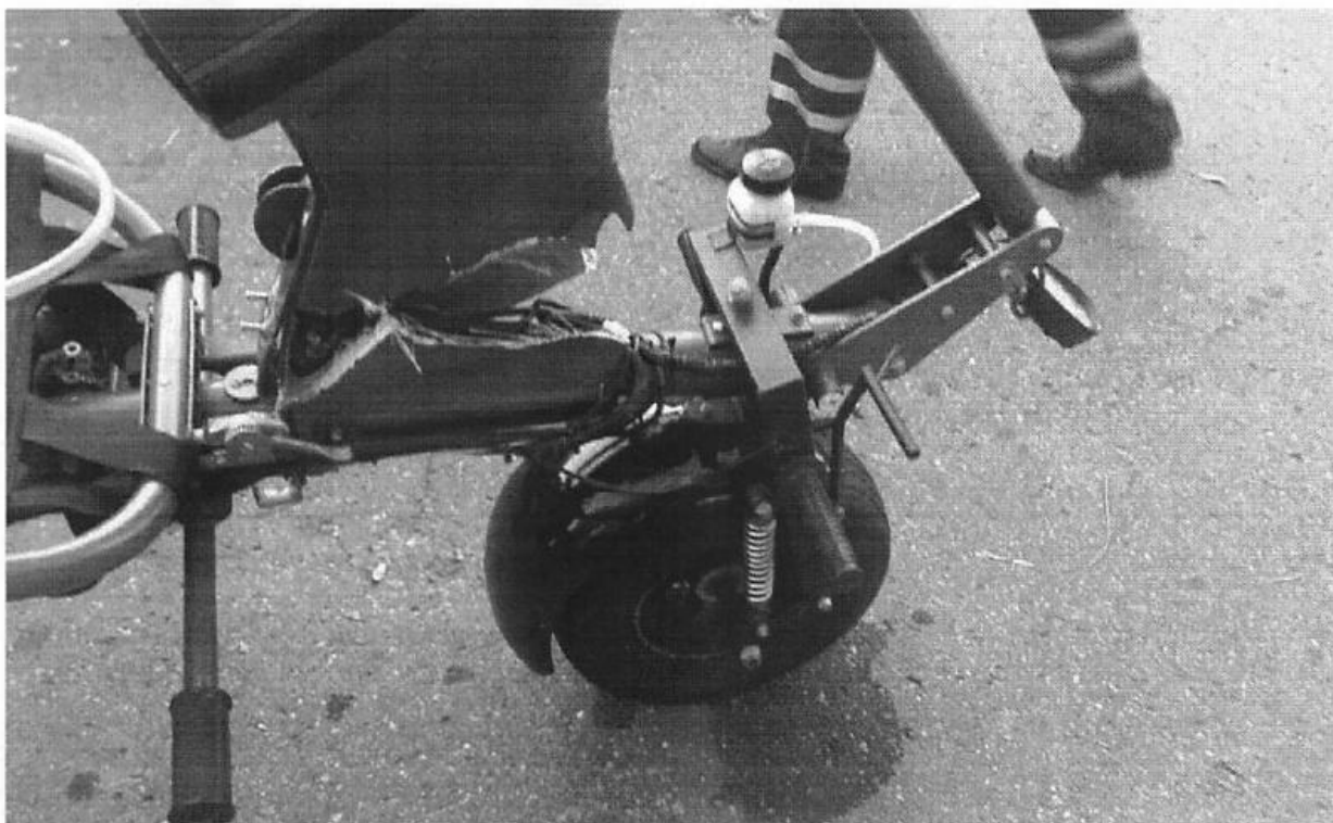
Фото 1. Повреждение обшивки обтекателя приборов
