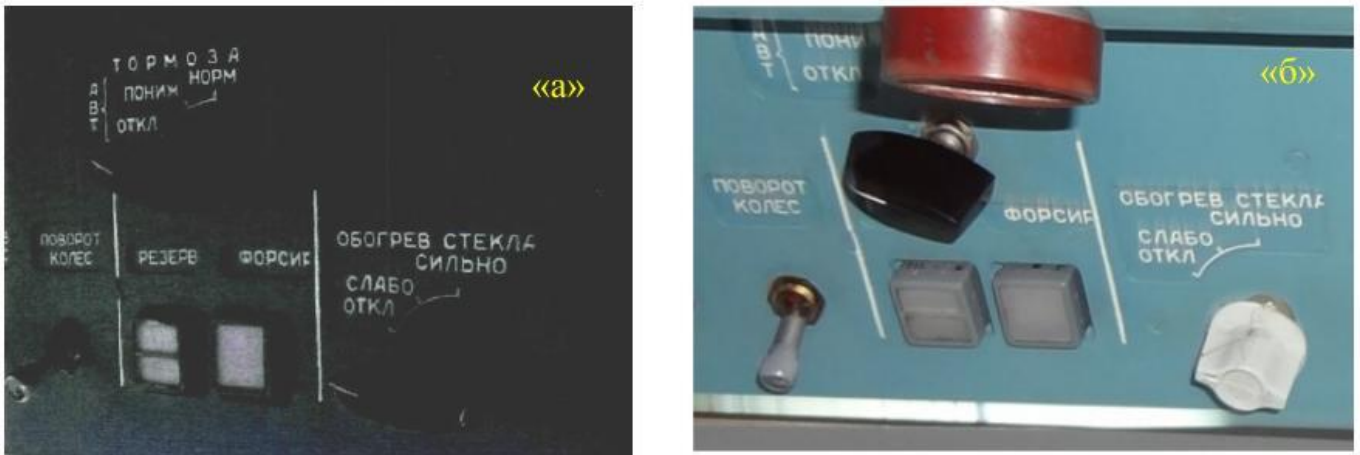
Рис. 2. Форма переключателей «Тормоза» и «Обогрев стекла» фактически установленных (а) и требуемых типовой конструкцией (б)
