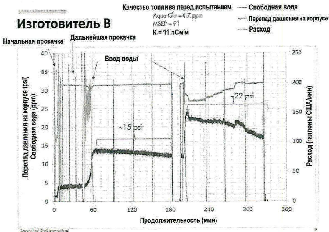
Рисунок 1 – Графическое изображение режима испытания, которому подвергался корпус фильтра монитора с десятью элементами 2" (каждая серийно производимая модель испытывается отдельно)
